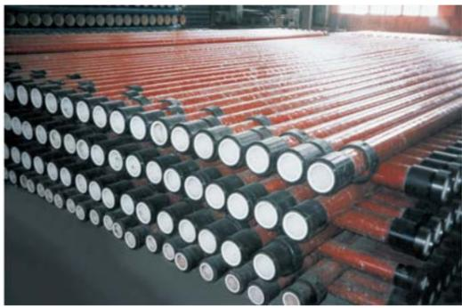
Стеклопластиковая композитная труба с термопластичной внутренней трубой изготавливается с полиэтиленом, полипропиленом и другими термопластиками в качестве внутренней футеровки, а со стеклопластиком из непрерывной намотки стекловолокна в качестве армированного слоя.
